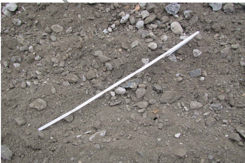
Foto 2: Detailaufnahme der recycelten Gesteinskörnung
